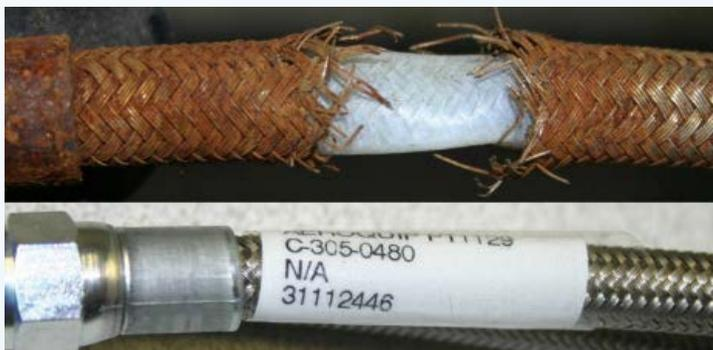
Le tressage INOX s'est corrodé sous l'étiquette. Le flexible ainsi fragilisé s'est rompu, aspergeant un opérateur à proximité avec du phosgène.
